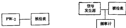
a) PW-2型外差频率计检频率刻度 (b) 计数式频率计检频率刻度
